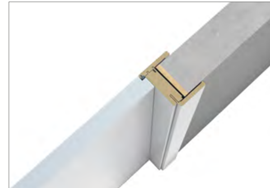
DETTAGLIO DELL'ANTA BORDATA SU TRE LATI. SEZIONE DEL TELAIO STANDARD DA 10.2 CM PER MURO DA 9.5 A 11 CM
